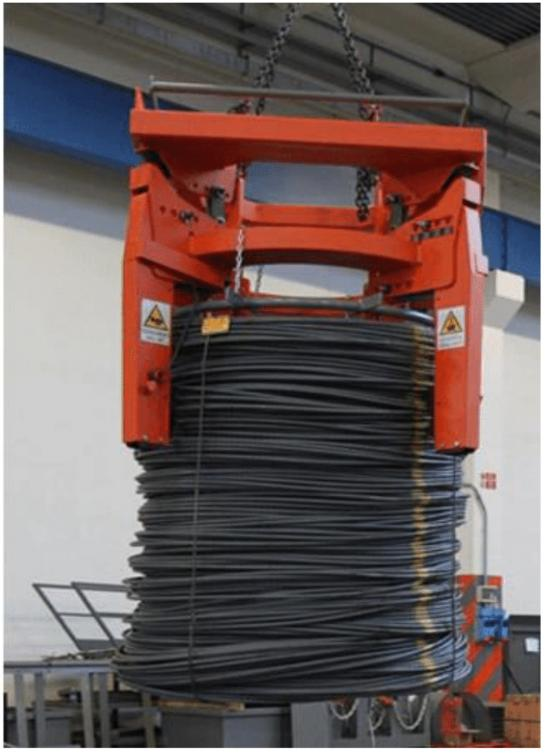
Coil Spider è una pinza per la movimentazione di bobine sicura e dalle dimensioni ridotte che, grazie alla sua forma innovativa, permette l'aggancio dall'esterno dei rotoli di trafilato e laminato (ribobinato o no).
